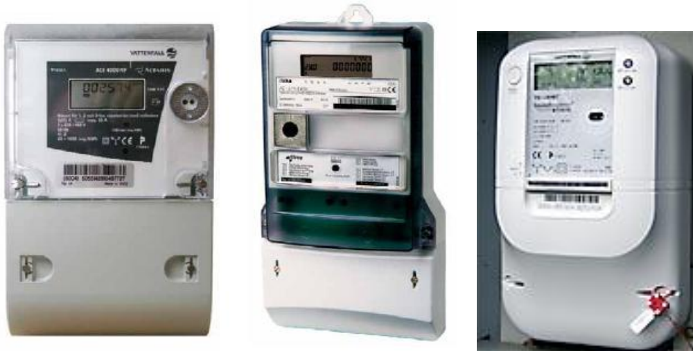
Figure 5.1 – Actaris (left), Iskraemeco (center) and Telvent (right) models, installed at customers of Vattenfall (Vattenfall 2007, Vågbrytaren Stockholm 2008)
